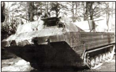
ПТС-2 – плаваючий транспортер. За його допомогою вивозили радіоактивні уламки і ґрунт у могильники.
