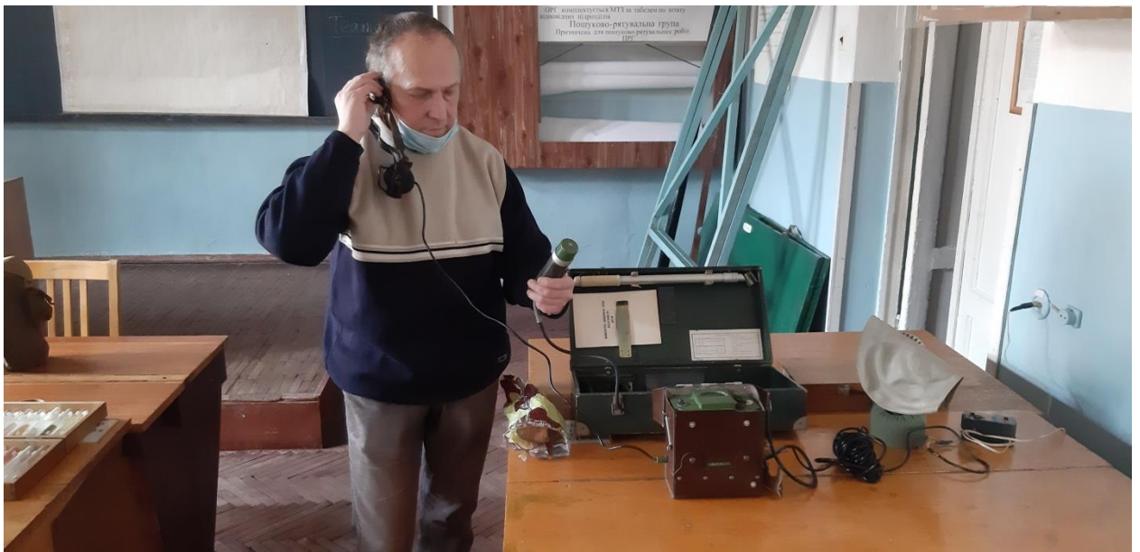
Командир ланки №1 Тамбовцев О. О. налаштовує роботу приладу радіаційної розвідки ДП 5В.
