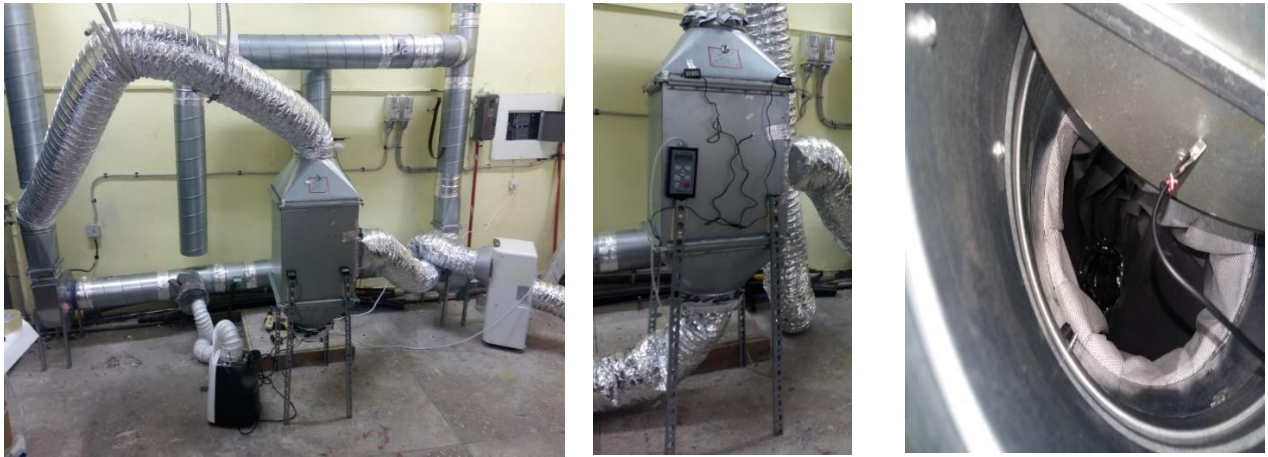
Рис. 7 Фото лабораторного стану для дослідження ізотермічного осушення повітря на ПВХ мембрані
