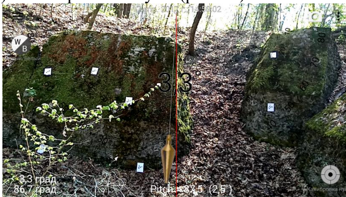
Рис. 22. Вимірювання кутів нахилу окремих елементів споруди
