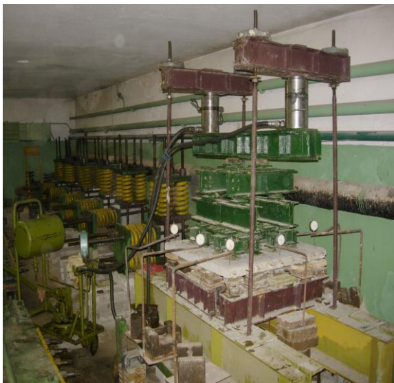
Рис. 21. Експериментальна установка для випробування дослідних плит
