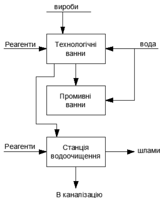
Рис. 1.3. Традиційна схема очистки металовмісних промислових стоків
