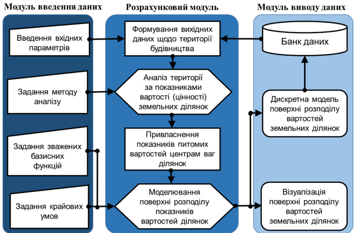
Рис. 4.2. Блок-схема програмного блоку «Моделювання розподілу питомих вартостей земельних ділянок» програмного комплексу моделювання ресурсоефективних мереж систем водопостачання
