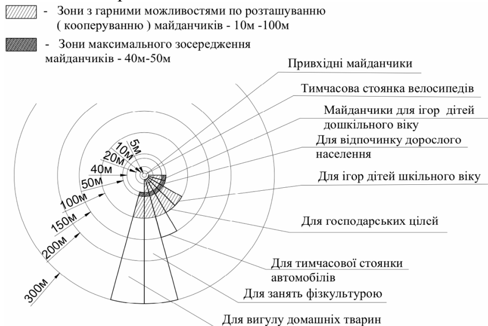
Рис.1. Схема розташування майданчиків прибудинкової території з врахуванням відстаней від вікон житлових будинків та радіусів обслуговування
