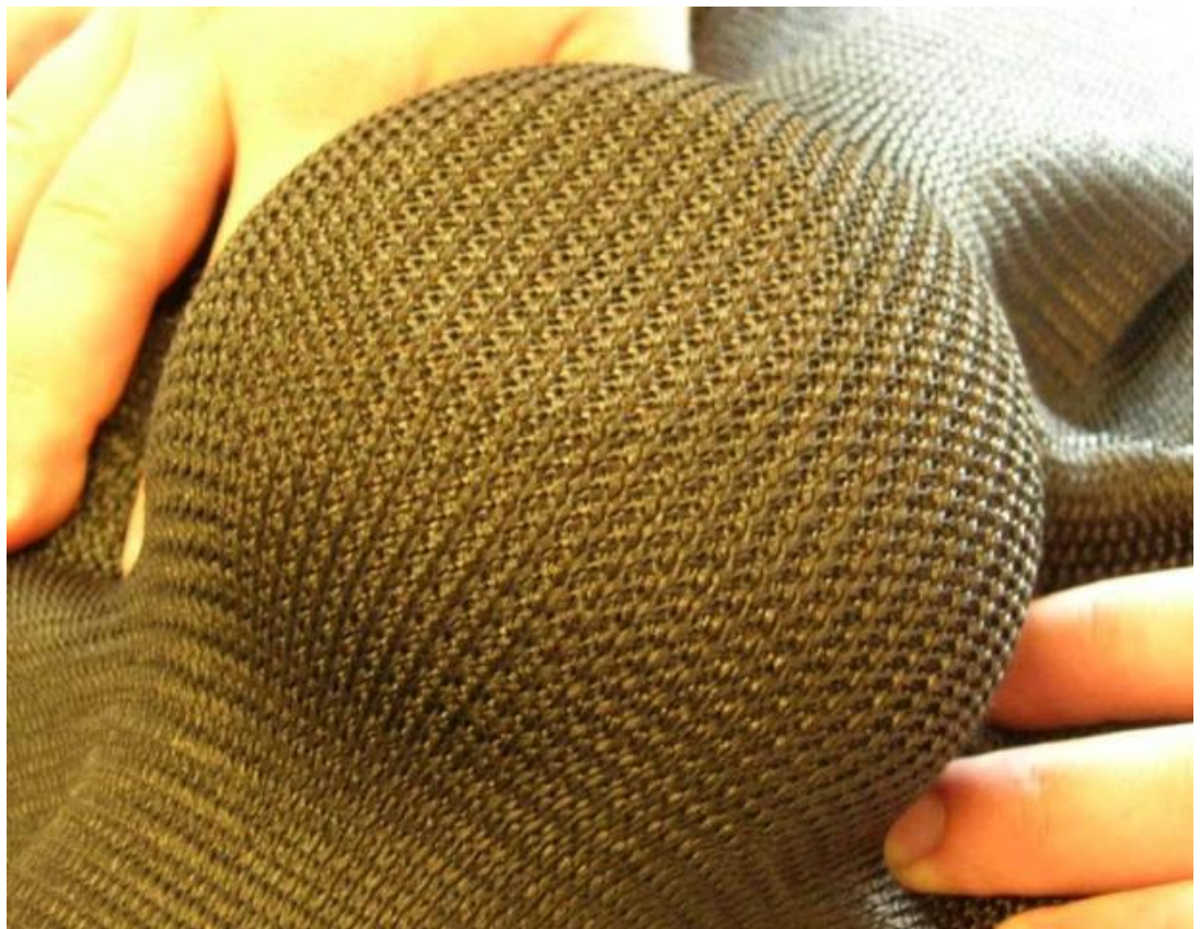
Рис. 2.1. Загальний вид вуглеграфітового трикотажного полотна: 1- досліджуване ВТП, що вироблене ППМ НАНУ ім. Францевича; 2- тканина марки УРАЛ-ТР (ГОСТ 28005-88) виробництва ОАО «СветлогорскХимволокно» (г. Светлогорск, Республіка Білорусь).
