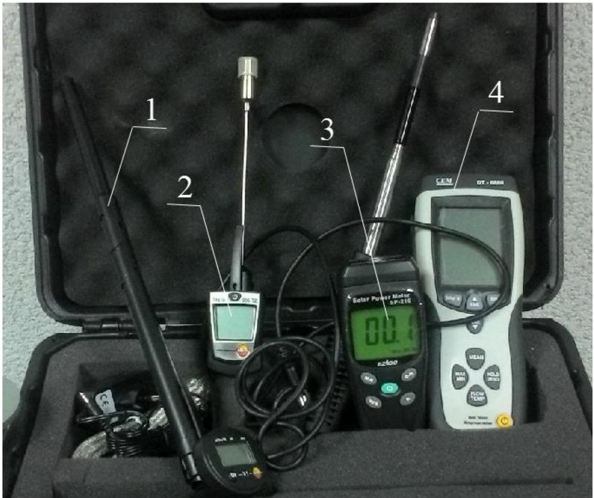
Рис. 3.6. Вимірювальні прилади: 1-термоанемометр testo 405-V1; 2 – контактний термометр testo 905-T2; 3 – піранометр (соляриметр) EZODO SP-216; 4 - термоанемометр CEM DT-8880.
