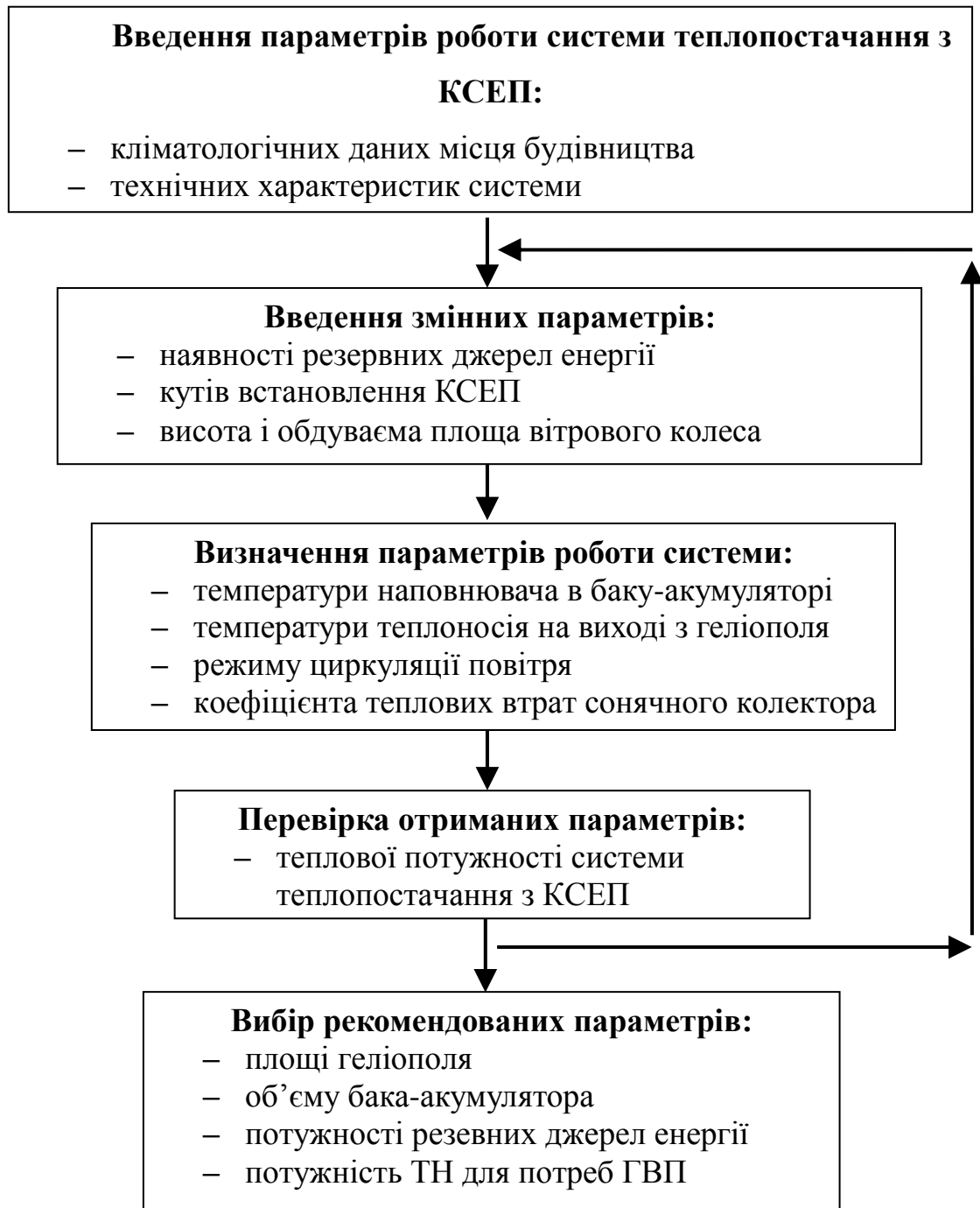
Рис. 4.4. Алгоритм розрахунку системи теплопостачання з КСЕП.
