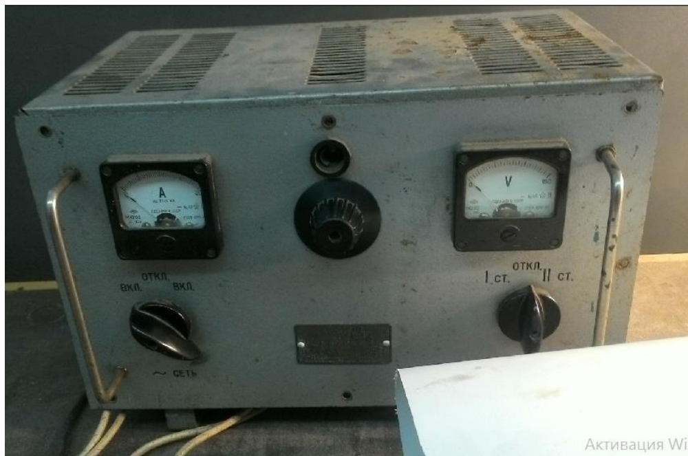
Рис. 3.3. Джерело електроенергії, зформоване з випрямляча, трансформатора та вимірювальної ділянки.
