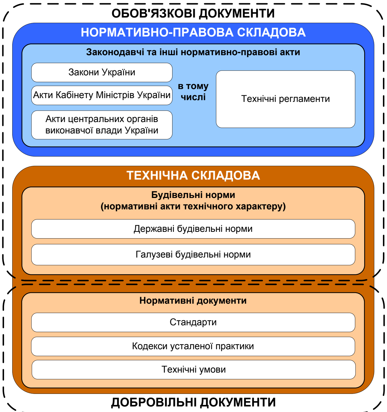
Рис. 2. Структура нормативної бази технічного регулювання у будівництві
