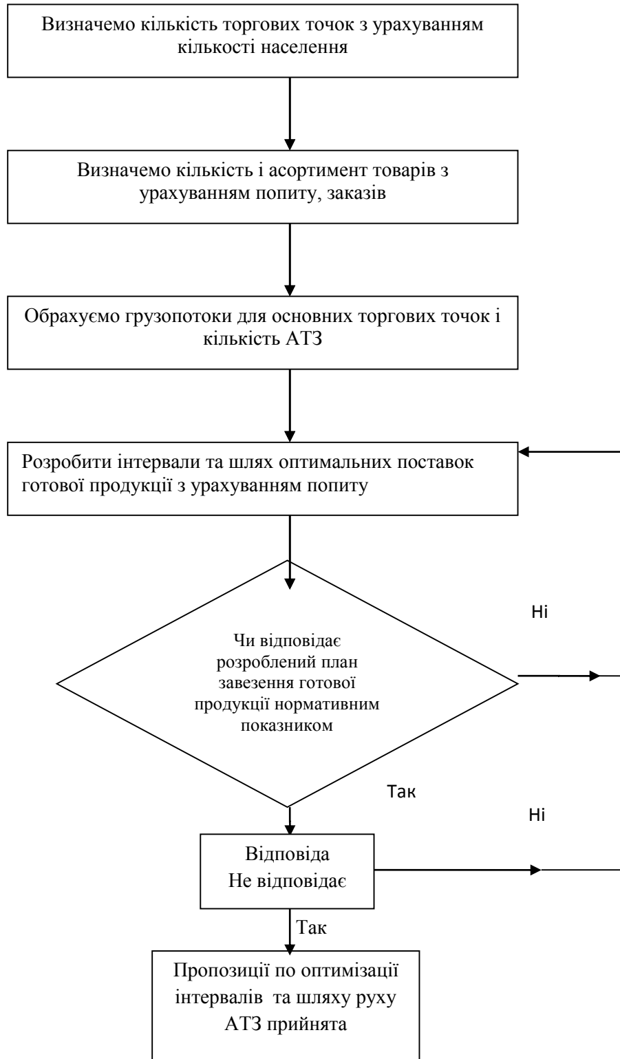
Рисунок 4.20 - Схема визначення оптимальних інтервалів часу та шлях доставки готової продукції до торгових точок АТЗ
