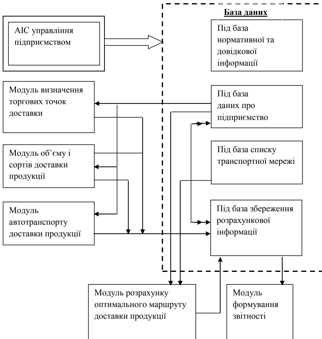
Рисунок 4.17 - Структурна схема взаємозв'язків між модулями і базою даних АІС
