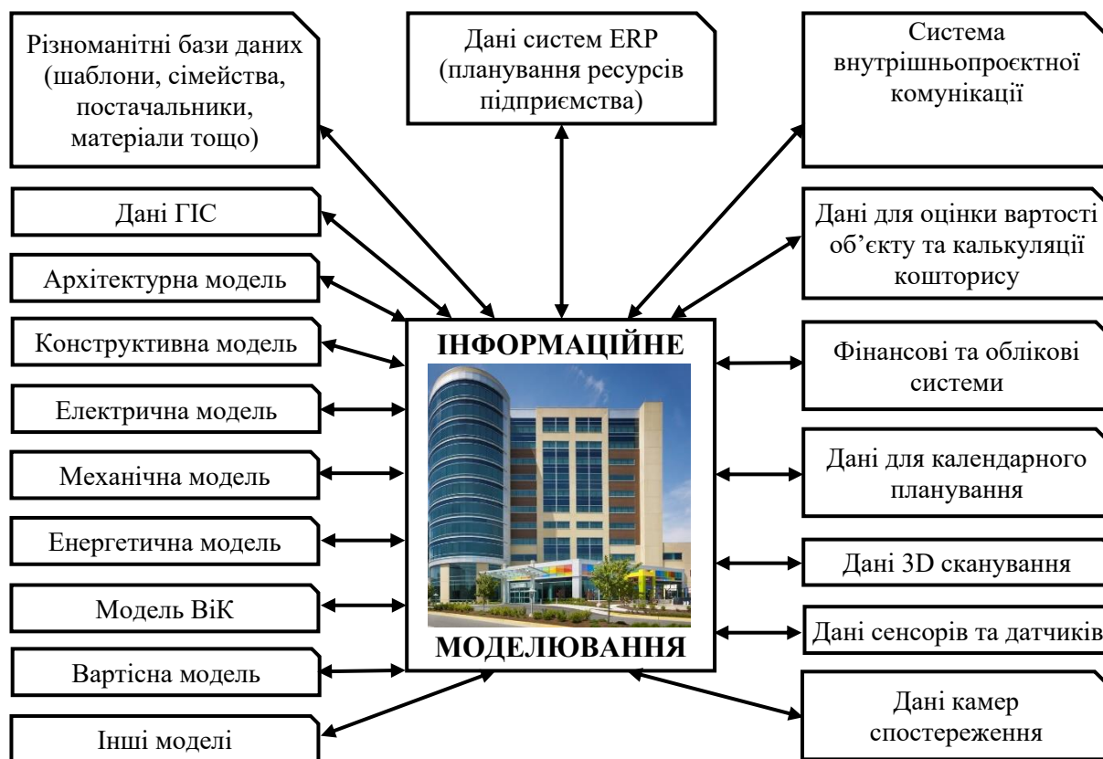
Рис. 12. Структура інформаційної моделі зберігання та обробки геометричної та негеометричної інформації про проєкт (розроблено автором)
