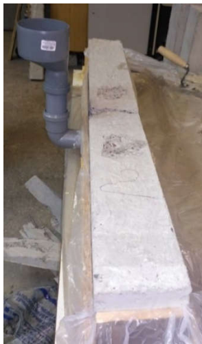
Рисунок 2. Балка встановлена в опалубку конструкцію та готова до відновлення
