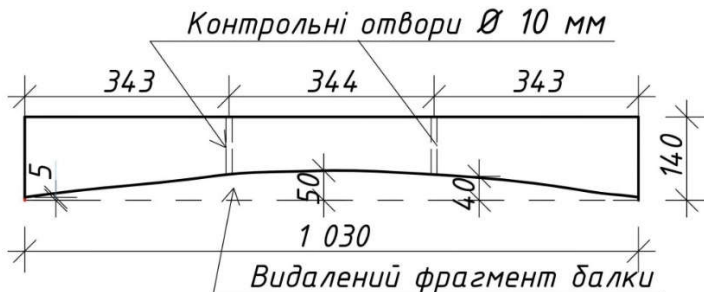
Рисунок 1. Схема балки підготовленої до відновлення
