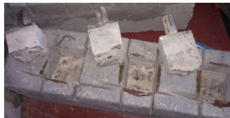
Рисунок 4. Вид руйнування зразків, які досліджували на міцність зчеплення з основою
