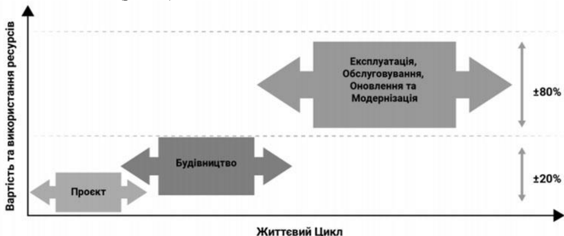
Рис. 3. Перерозподіл вартості та використання ресурсів по результатах впровадження BIM-технології
