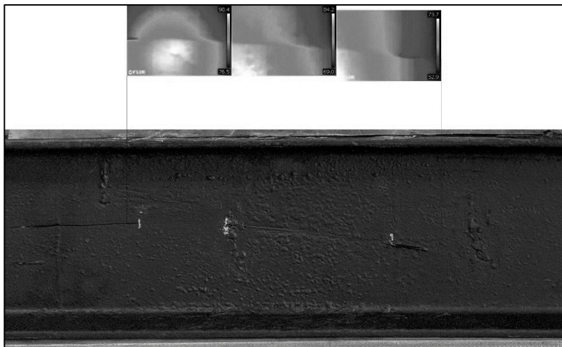
Рис. 7. Компіляція цифрового та інфрачервоного зображення досліджуваного зразку №1
