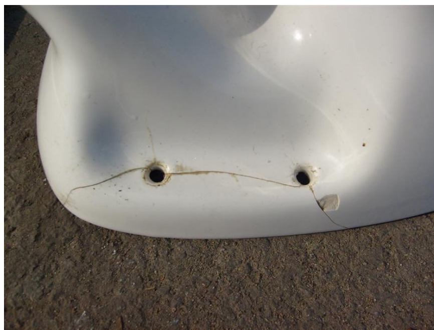
Рис.2.4. Розтріскування місць кріплення унітазу
