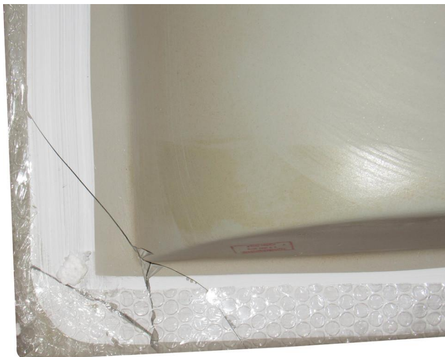
Рис.2.3. Пошкодження раковини при транспортуванні
