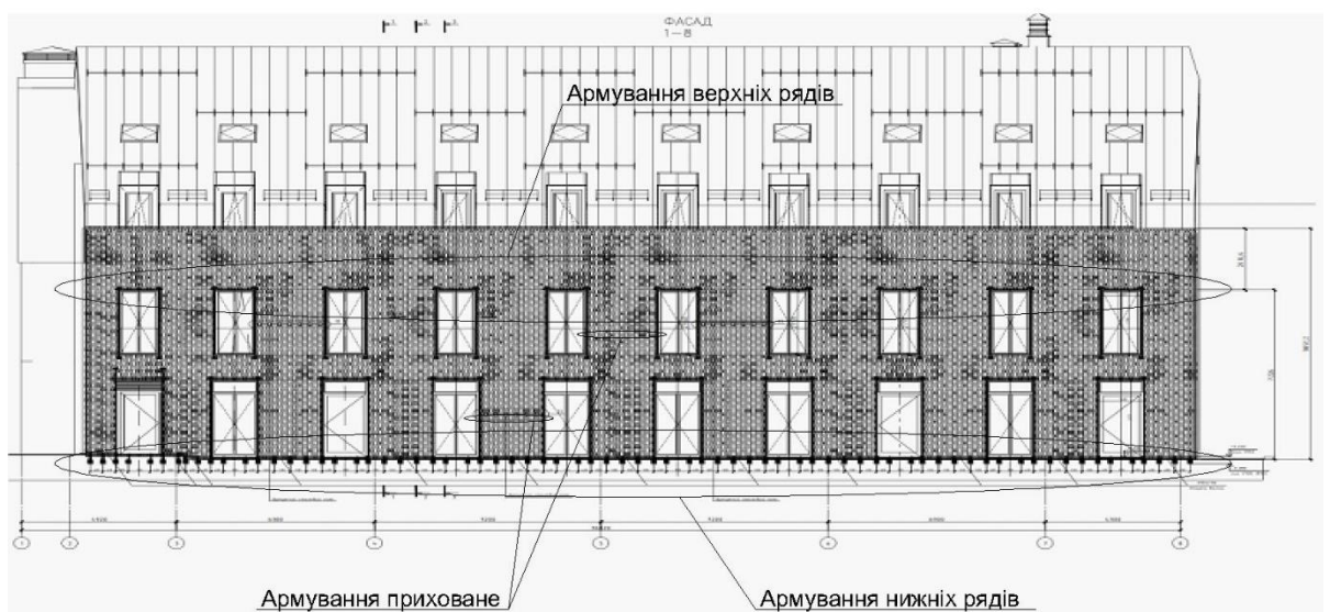
Рисунок 4.3 – Конструктивне рішення зовнішніх стін фрагменту фасаду
